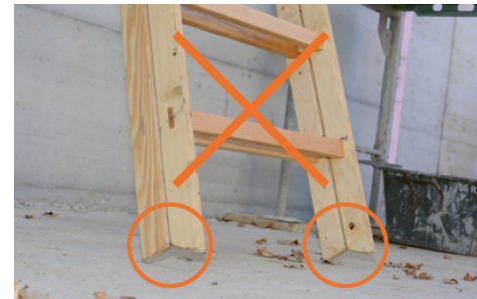
Bockleitern dürfen nicht als Anstellleitern verwendet werden
