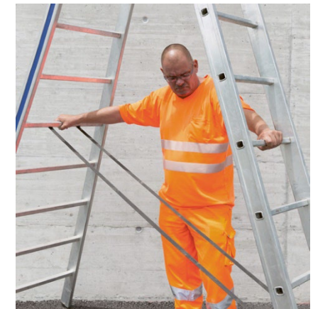
Wirksame Spreizsicherung, immer komplett spannen
