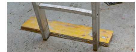
Sichern mit einem befestigten Brett
