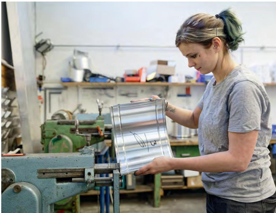
ken zum Teil recht einfach, haben dafür aber umso mehr drauf. «Dieses Gerät hier zum Beispiel kann ringförmige Vertiefungen im Blech erzeugen, überall und in allen Breiten und Tiefen», erklärt die Isolierspenglerin das Sicken.
